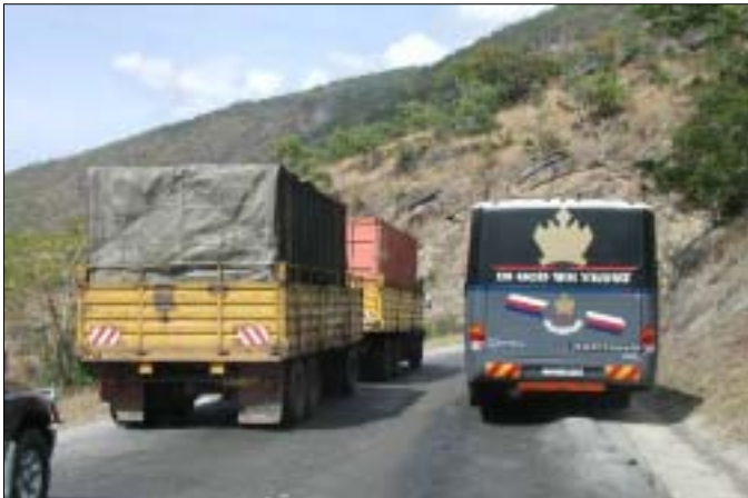
追い越し時、轍掘れを避けて 側溝上を走る路線バス
