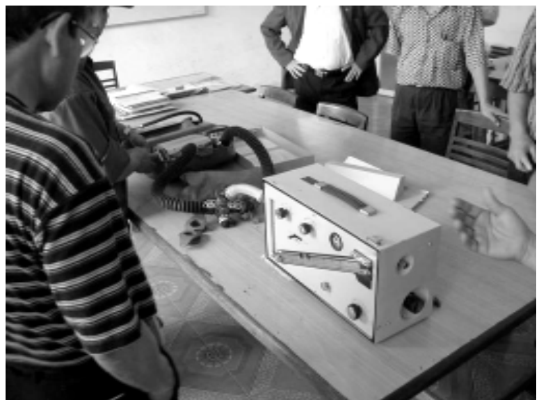
試験装置による呼吸器性能試験
