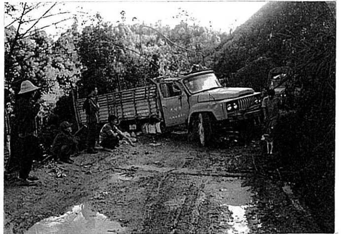
幹線(雨期) トラックのスリップ脱輪
