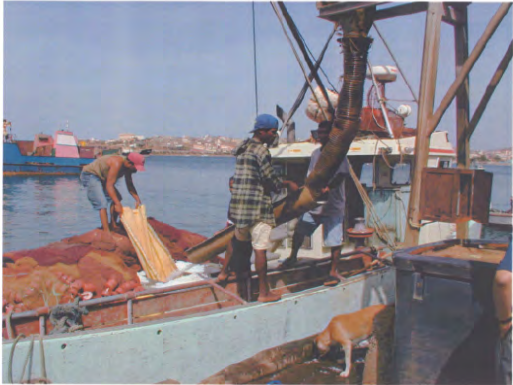
写真7 氷の積み込み状況（ハッチへの直接積み込み）
