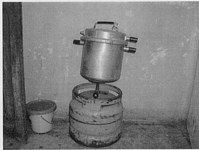
写真-18 注射針滅菌器をガスポンベにかけ、煮沸する。
