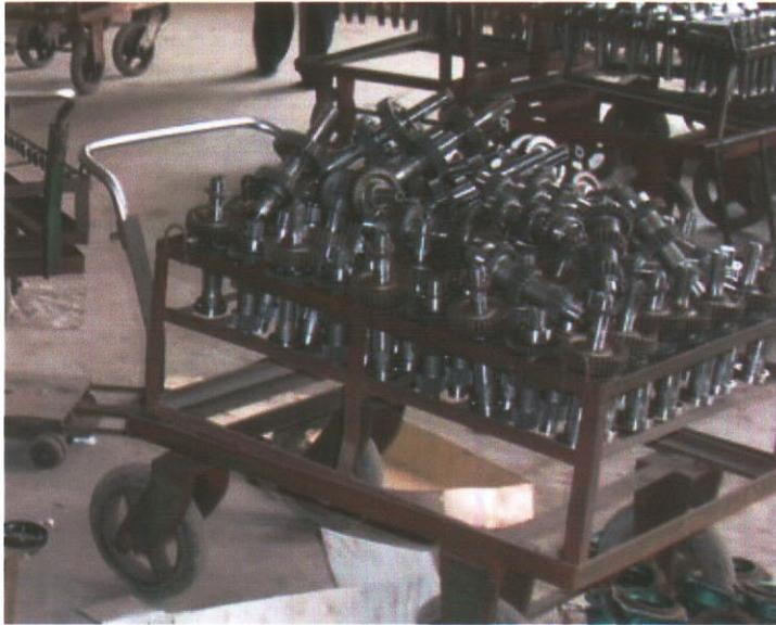
組み込み前の歯車は台車に山積みされて組立てラインに供給される。研磨した車軸の嵌め合い面に傷が付くことが考えられる。
