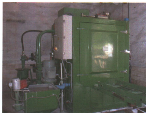
図 3.14 液体サンドショット機 (SS-7B)
