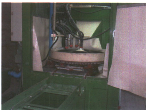
図 3.14 液体サンドショット機 (SS-7B)
