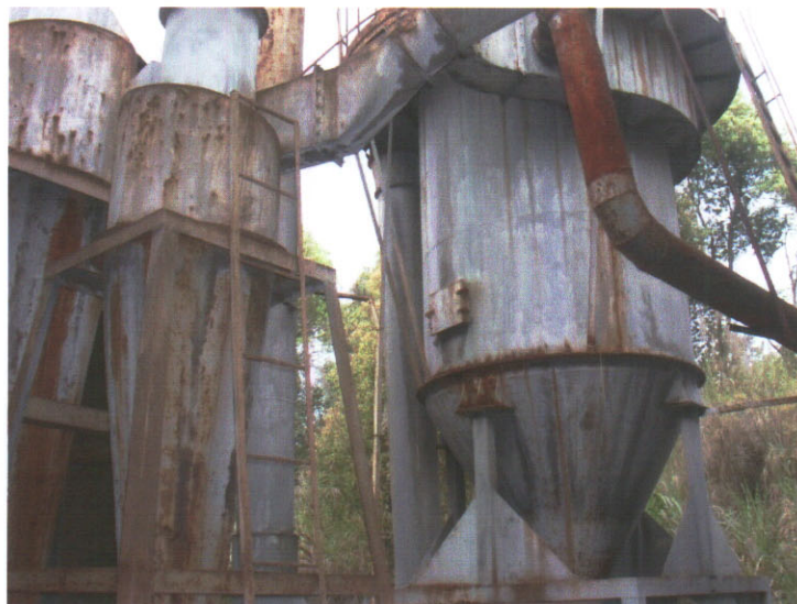
図 3.13 ショットブラスト粉塵の処理設備
