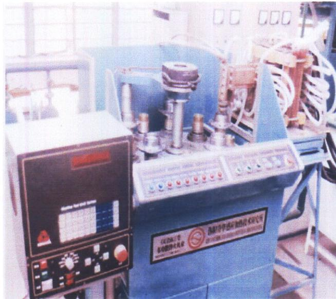
図 5.3 ベアリングレースの高周波加熱自動化ライン
