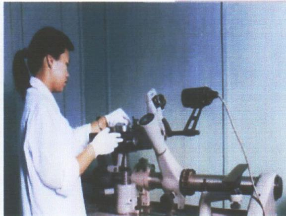
図 5.5 高精度水平比較儀
