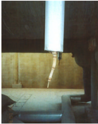
図1 現状のVCM サンプリングノズル
