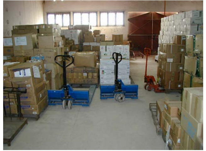
写真20 同第3区画 パレットの移動には手動式フォークリフトが用いられる。
