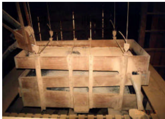
ロータリーシフター（米選別機） 大型化し、小碎粒の除去率を高める必要がある。目詰まり防止の工夫も必要である。
