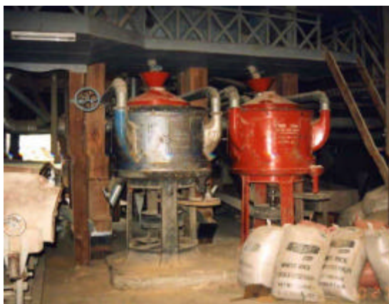
縦型研削式精米機 2連または3連配置が主流である。
