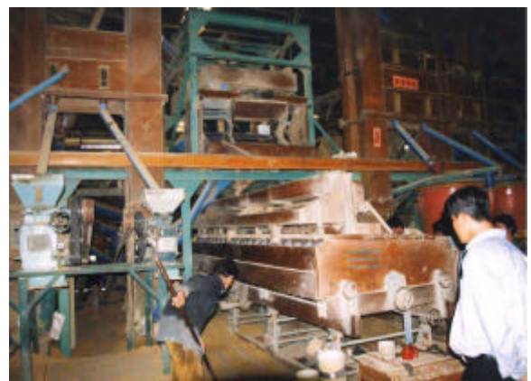
ゴムロール式初摺機と初選別機 碎米発生が少ないゴムロール式を使用する精米所が増えているが、脱ぶ率が50-60%と低い。
