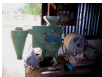
ロータリーシフター（米選別機） 大型化し、小碎粒の除去率を高める必要がある。目詰まり防止の工夫も必要である。
