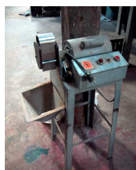
ロータリーシフター（米選別機） 大型化し、小碎粒の除去率を高める必要がある。目詰まり防止の工夫も必要である。
