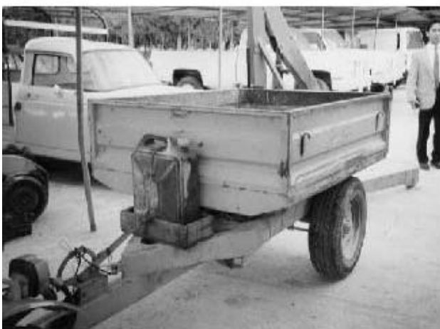
遺跡内の土砂運搬用トレーラ： トレーラはトラクターにより牽引され、土砂等を積載し、運搬する。
