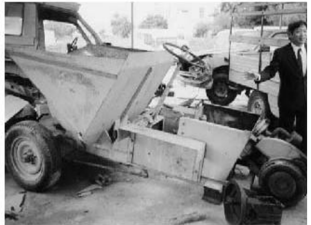
石材運搬用機材（通称ダンパー）： 構造がシンプルで運搬車は特に運転の技能を要さない。一方、積載量が約400kgと低いため、作業量は限られる。本計画では要請機材に含まれていない。
