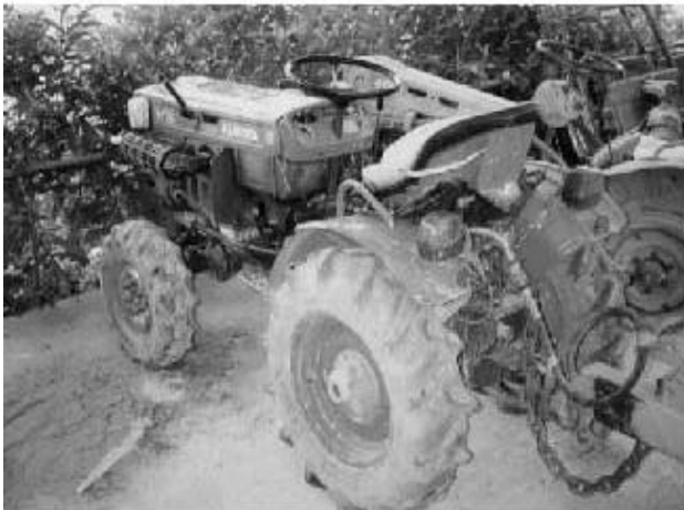
遺跡内の土砂運搬用トラクター： 遺跡内の通路は幅員が3～4mであるため農耕用トラクターとトレーラーが活躍している。
