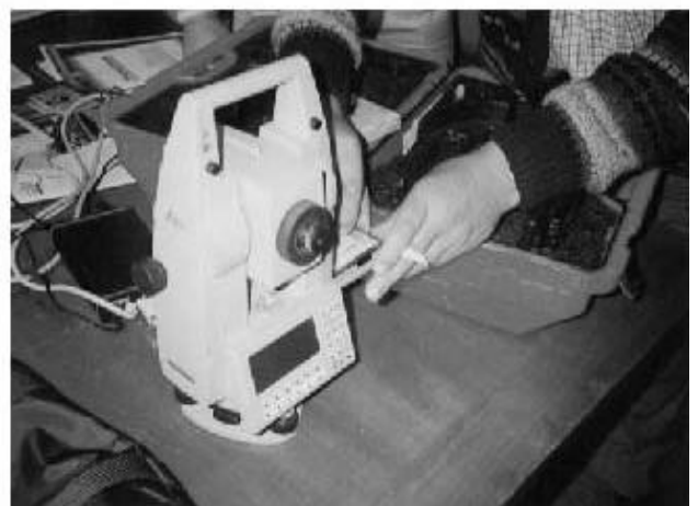
現有機材のトータルステーション： 遺跡の測量に使用されている。データをカードに入力し、コンピュータ処理を行う。
