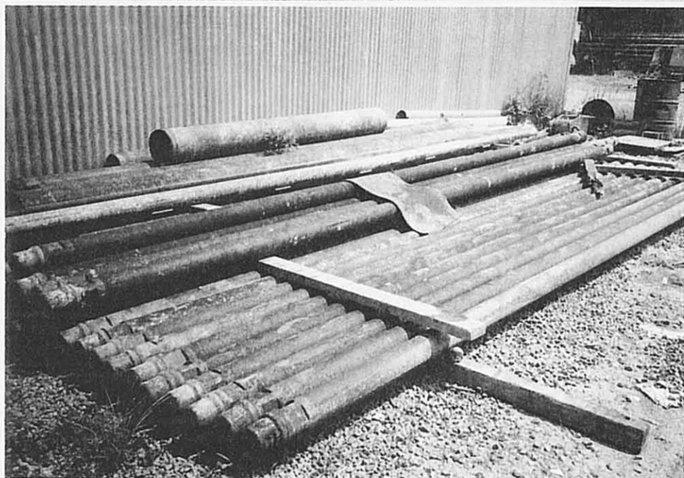
写真17 Matsapha 中央ワークショ ップ、第1次地方給水計 画供与機材 ドリルパイプ(ねじ山保 護のためにキャップして 保管) Manzini 県
