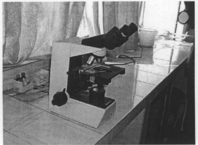
喀痰検査用顕微鏡（日本製の双眼顕微鏡）
