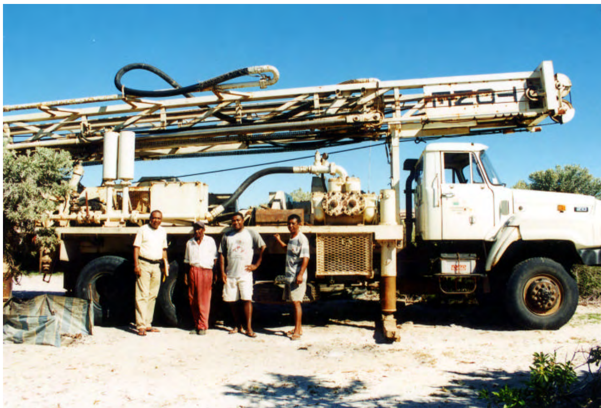
UNDPによるチュリール州最南部地域地下水開発計画に利用されている1993年調達 掘さく機、大型トラック、コンプレッサ。本計画で整備し、掘さくに利用。 (2000年12月UNDPキャンプにて撮影。)
