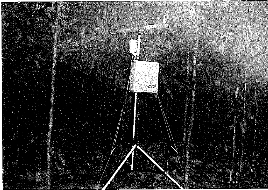
ZF-2 のベルトトランセクト (20m×2,500m) 内に設置した気象観測装置。
