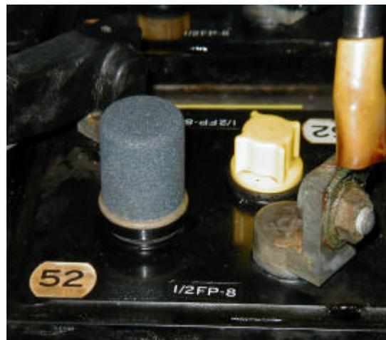
寿命末期の発電所制御用バッテリー(左：内部の異物の沈殿 右：ケースのひび割れ，端子の発錆)
