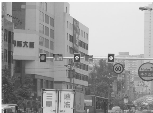
图 3.4.4 车道控制与流入部控制（LED 与原来型） 车线控制（LED） 流入部控制（原来型）
