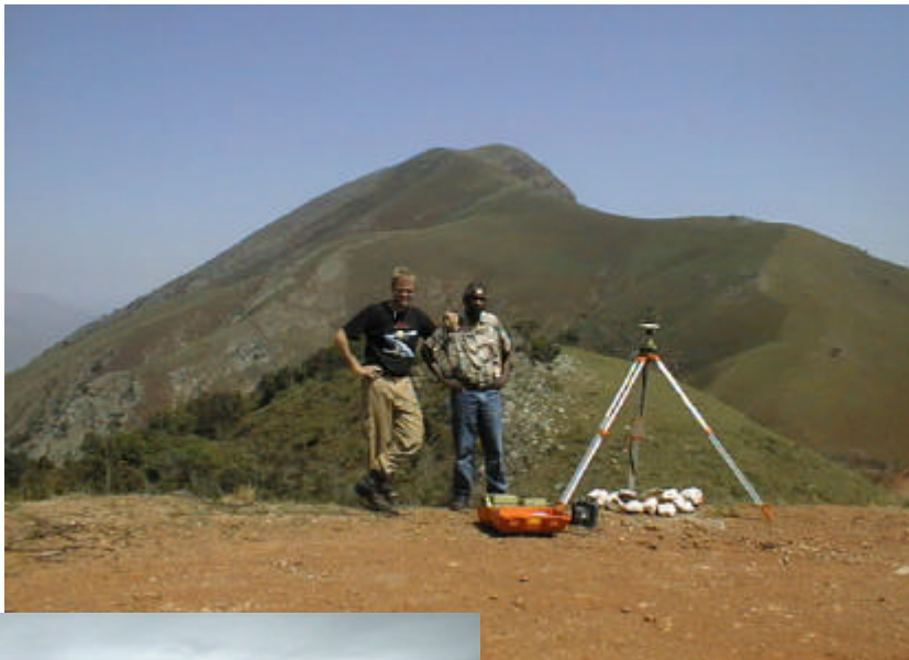
GPSを用いた標定点 測量観測風景
