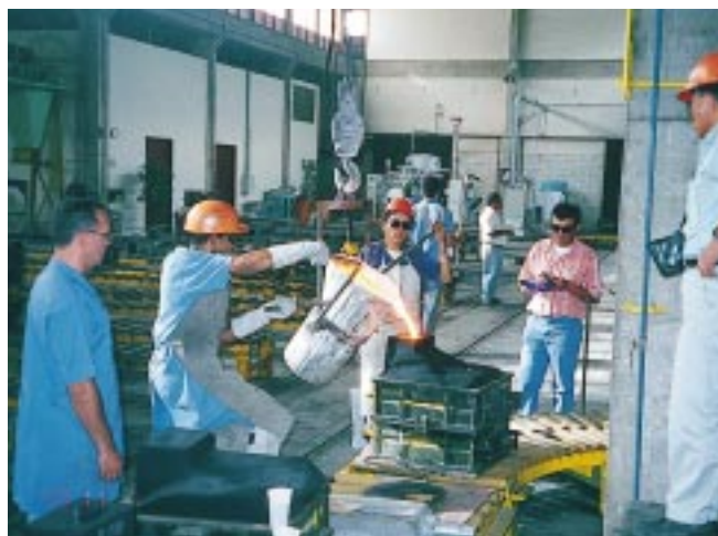
鑄型への鑄込み作業を指導する専門家(ブラジル「中小企業鑄造技術向上」)
