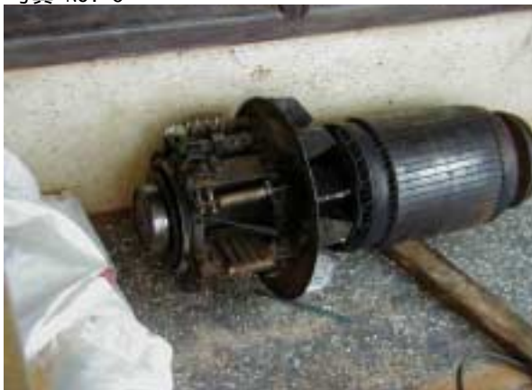
No.3取水ポンプの電動機のローター（回転子） 回転子が黒く焼けている。
