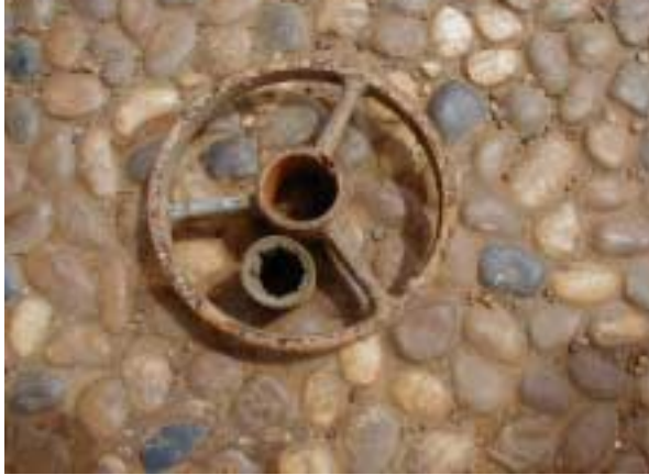
取水ポンプの中間軸受（NPSがベトナム業者に制作させたもの）
