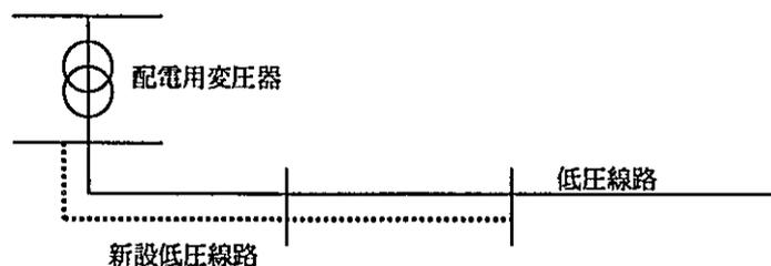
図 3-3 上位電圧導入(配電用変圧器新設)
