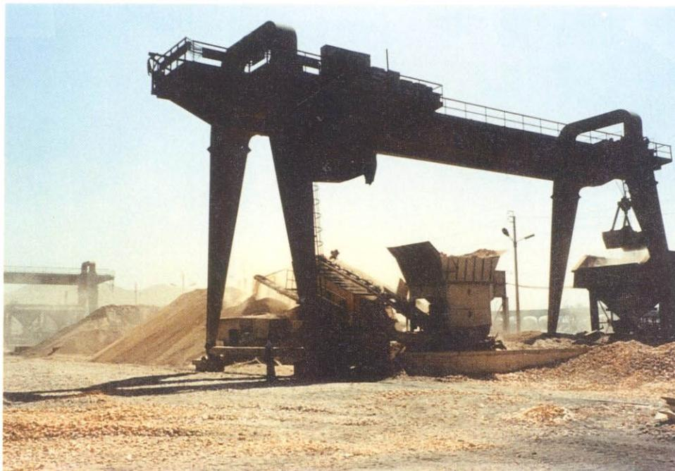
写真 EF-4 破碎機および選別機
