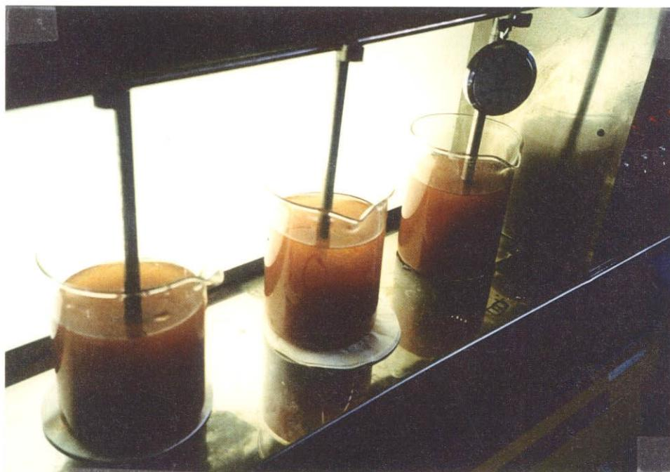
写真 EIS-5 Rinsing Water の凝集試験 (TIMS)
