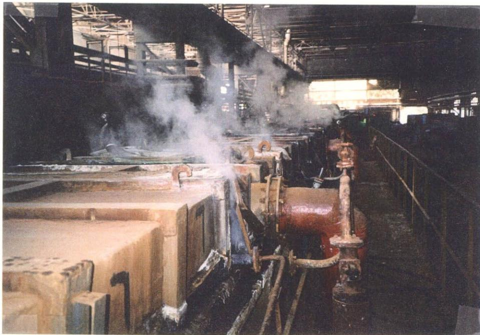
写真 EIS-2 酸洗設備の後半, 水洗工程(Rinsing)
