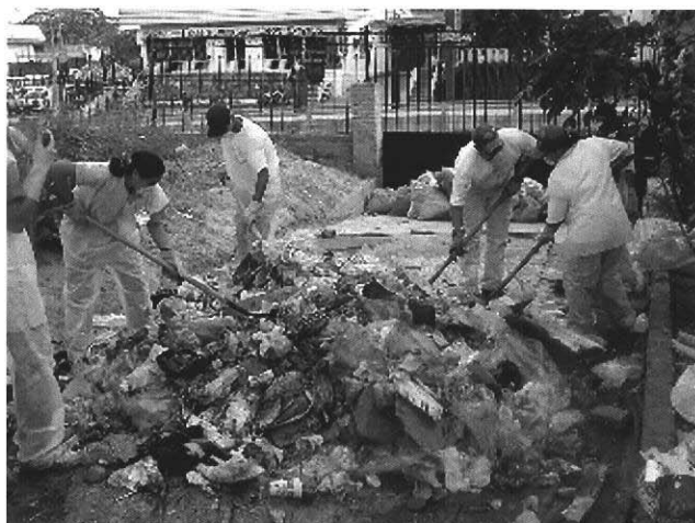
サンプルごみの均一化を図るため、混ぜ合わせて混合サンプルを作る
