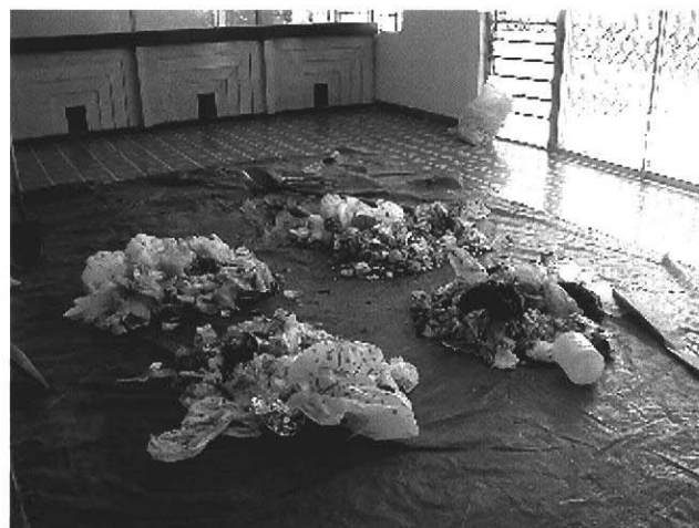
ごみ質の均一化を図りごみ量を減じるために、ごみを4等分する
