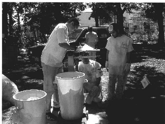
4分法を繰り返して適量となったごみサンプルの重量を測定し、見かけ比重を算出する
