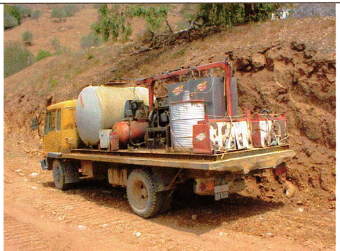
Taounate 県内の工事現場で活動する給油脂車 (SLM-Fes)；今回の要請機材でもある。給油装備のコンテナバーは取り外してある
