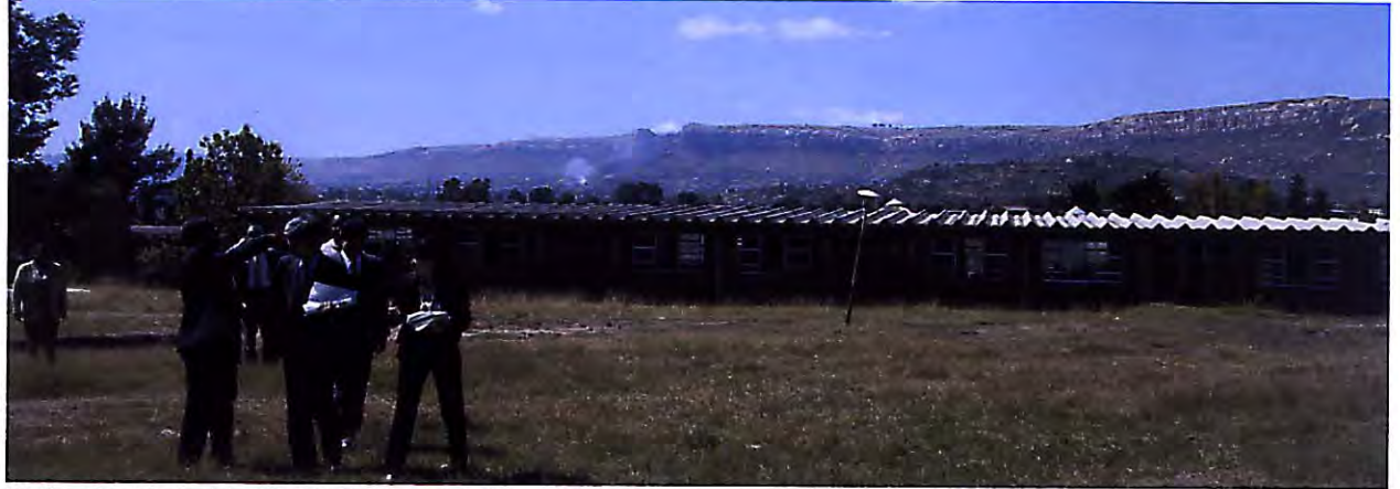
②プロジェクトサイト西側より実験棟方向を望む。敷地は東西方向に約70m程あるが、測量調査によれば東西両側で約3mの高低差がある。本件では、盛土・切土がなるべく生じないよう、敷地東側に設けるプラザからどこからでも建物内部へアプローチできるようにし、建物前面に一様に階段を設けることにより、高低差を処理する計画としている。
