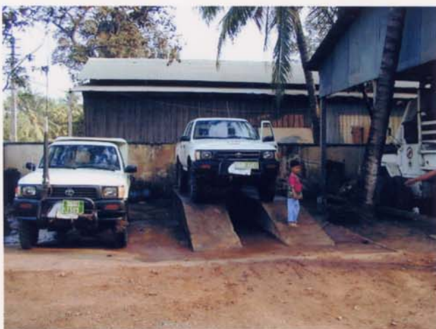
D/U2オフィス敷地内の簡易整備ピット
