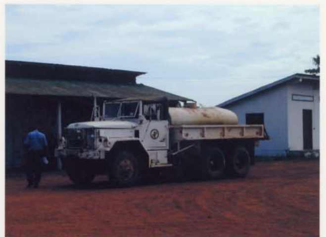
水タンクトレーラー(タンク容量1000リットル)を搭載したトラック
