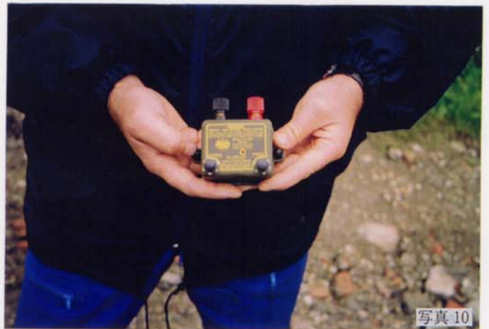
写真10 起爆スイッチ：米製
