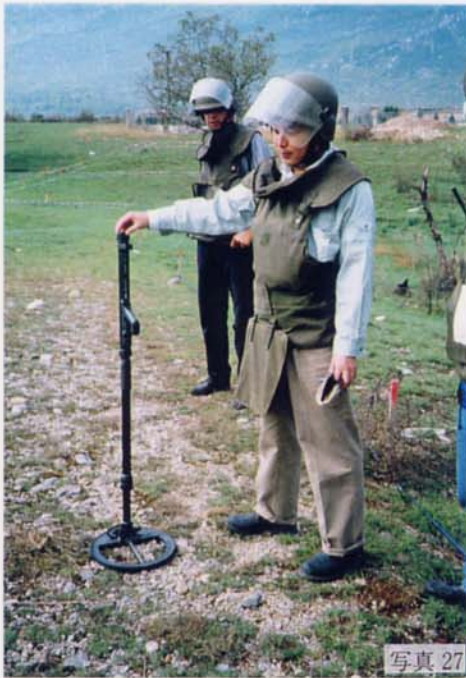
写真 27 モスタルで使用されている探知機：軽量で精度も良い。
