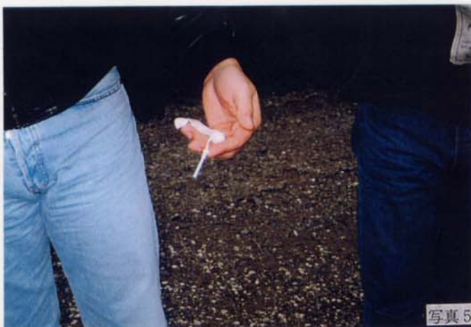
写真5 起爆用ヒューズ：最終処理に使用する。
