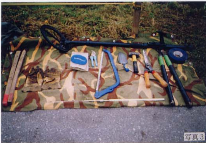
写真3 RSMACの地雷除去機材： UNMACから引き継いだもの。3年～4年使用に老朽化している。
