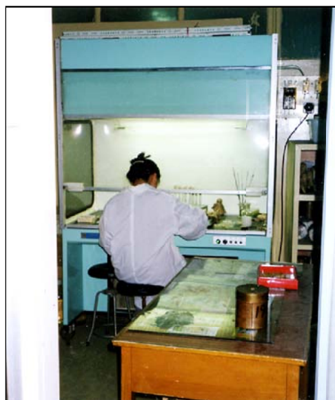
クリーンベンチ作業 生物防治研究所
