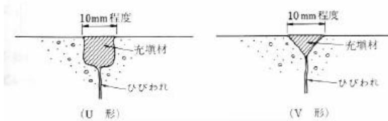
図 3.3.1 鉄筋が腐食していない場合の充填工法
