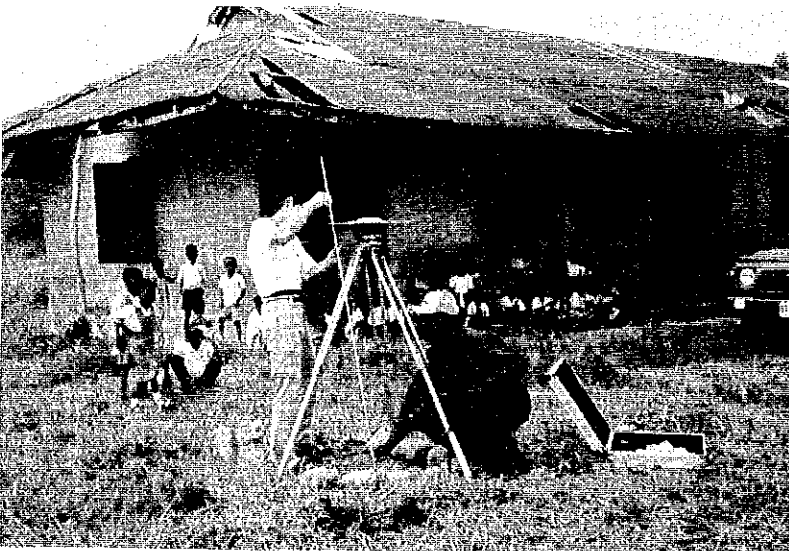
同 上 (アンテナ高の測定)
