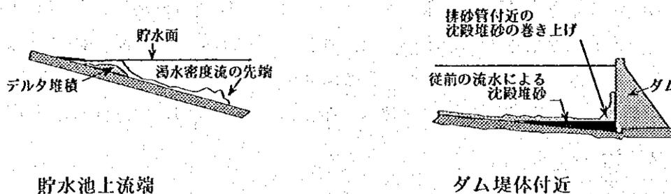
図 3.5.7 貯水池内における高濃度の浮遊土砂の状況
