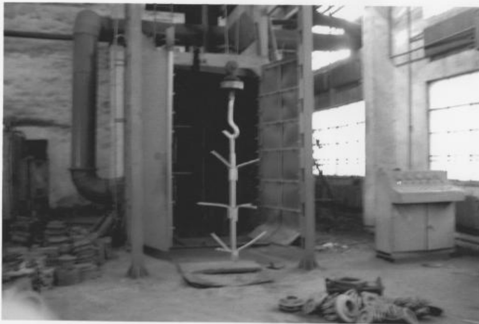
写真 2-2-10 大物部品鋳鋼工場のサンドブラスト
