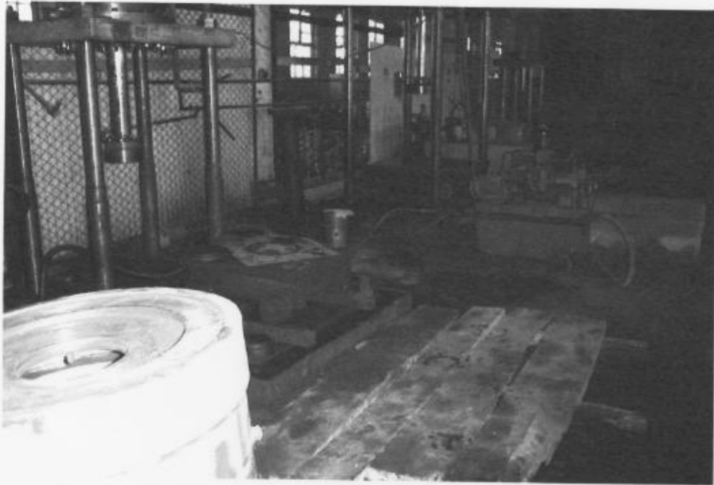
写真2-4-1 組立工場の水圧テスト用水圧プレス
