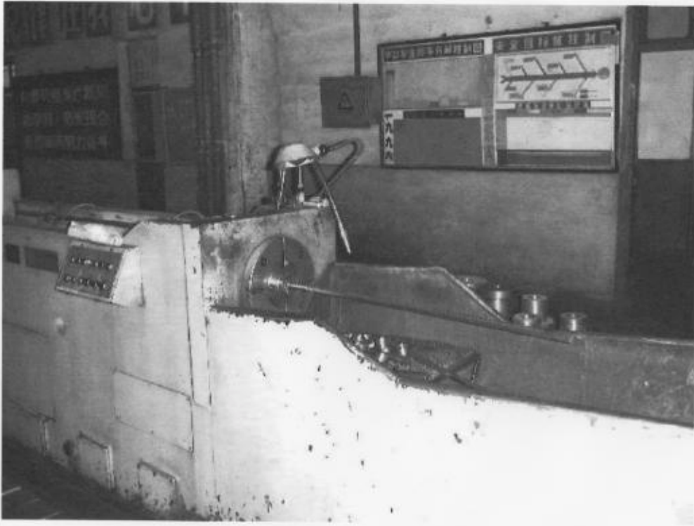
写真 2-3-3 キー溝加工用ブローチ盤
