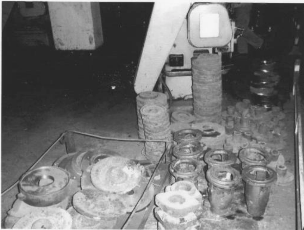
写真2-1-3 機械工場に搬入された鋳物素材
