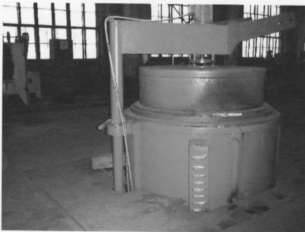
写真 2-3-7 工具工場のシャフト用熱処理炉
