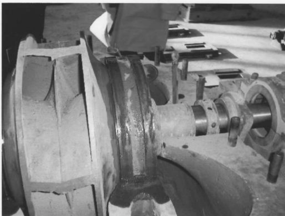
写真 2-1-1 仕上不良の羽根車
