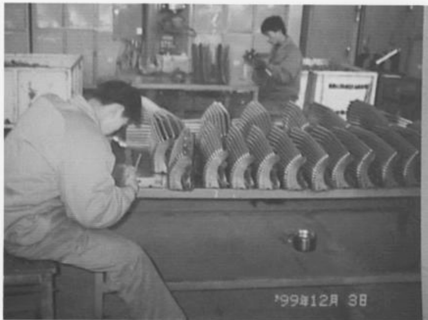
写真2-5-2 ウェルドナットのタップ立て 補助アーク溶接後、全数タップ立て作業。
