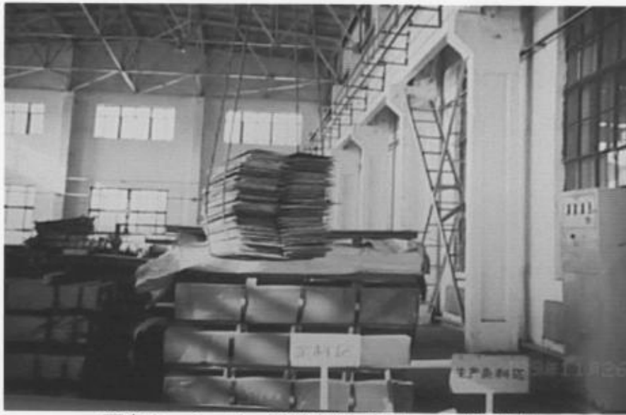
写真2-2-1 切断材をワイヤーで直か吊り 積み重ねた切断材をワイヤーで直に吊り上げ、荷崩れが起きている。
