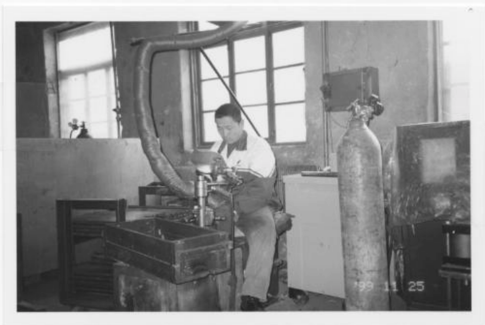
写真：4-2-5 半自動アルゴン 溶接
