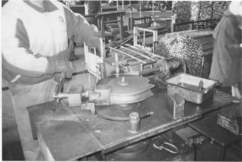
写真・3-2-1 排気管の曲げ装置
