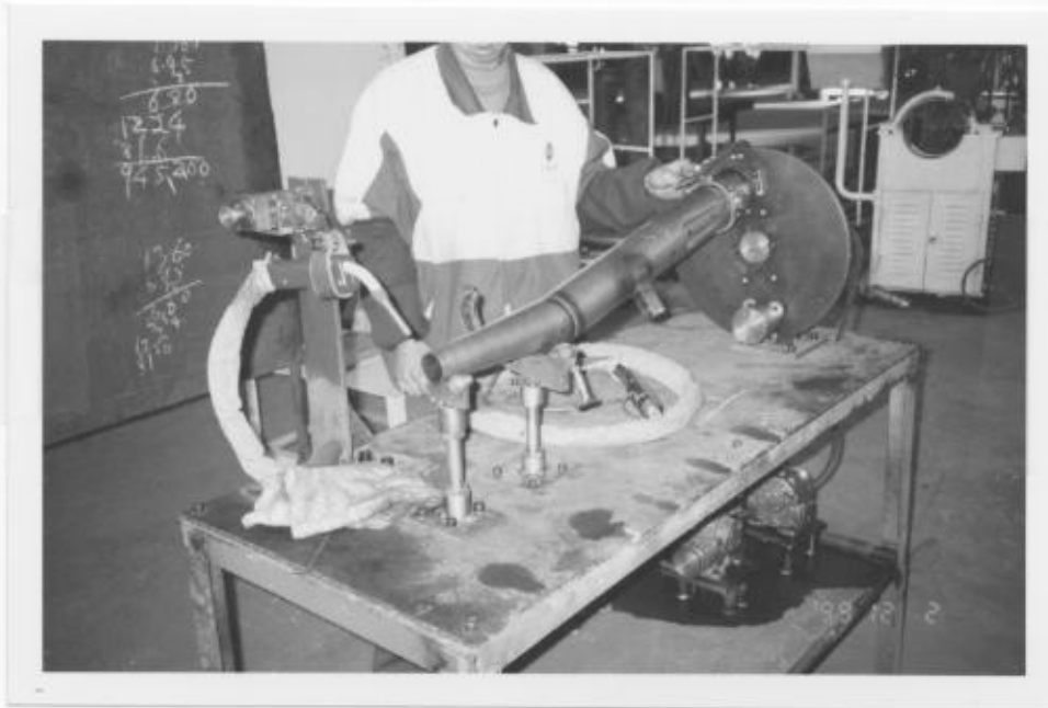
写真・3-2-5 CO2溶接治具
