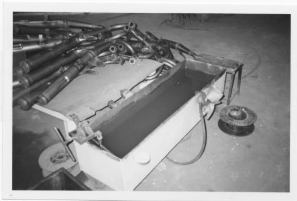
写真・3-2-7 検査工程の水密検査装置
