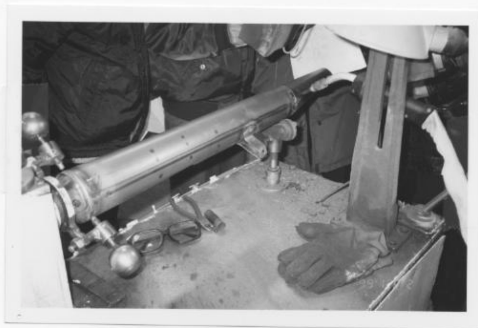
写真・3-2-4 CO2溶接および治具
