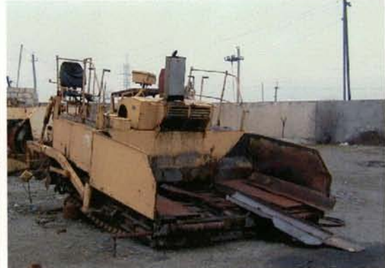
アスファルトフィニッシャー クローラーが磨り減っており、稼動できない状態である。
