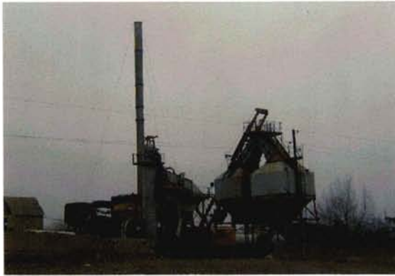
ドイツ製アスファルトプラント（100 トン/時） この他にロシア製（25 トン/時）も在る。
