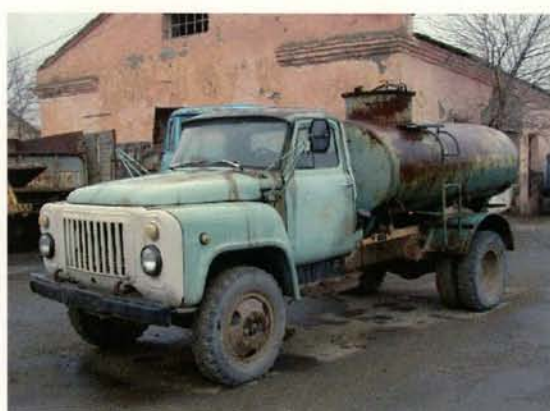
給水車：舗装補修工事には不可欠な車両である。ASC が使用できるとして要請には含めなかった。
