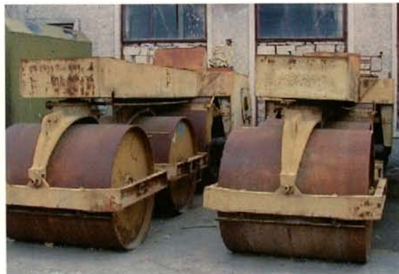
アゼルバイジャンで製造されたローラー（15トン）。エンジンはロシア製でシャシーをアゼルバイジャンで製造していたが、現在はエンジンの供給が止まっているため製造は中断しているとのことであった。
