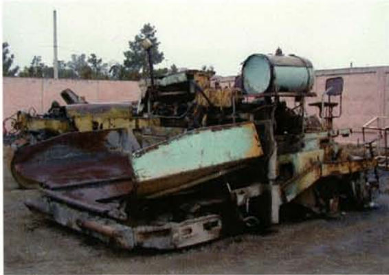
旧式アスファルトフィニッシャー 老朽化が著しく、使用できる状態ではない。
