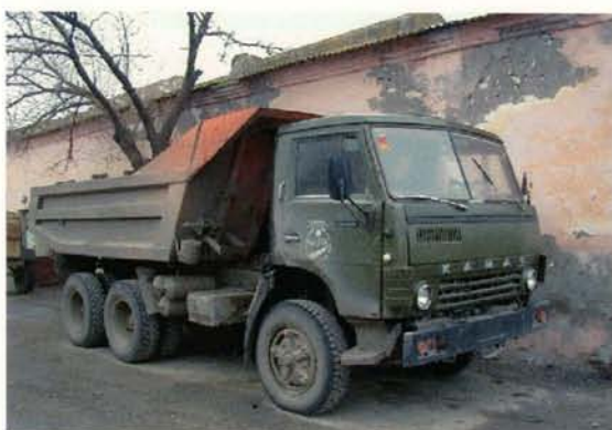
ロシア製ダンプトラック（CAMUS）：舗装材料や土砂の運搬に使用される。
