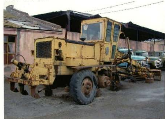
モーターグレーダー 老朽化により、使用不可の状態である。
