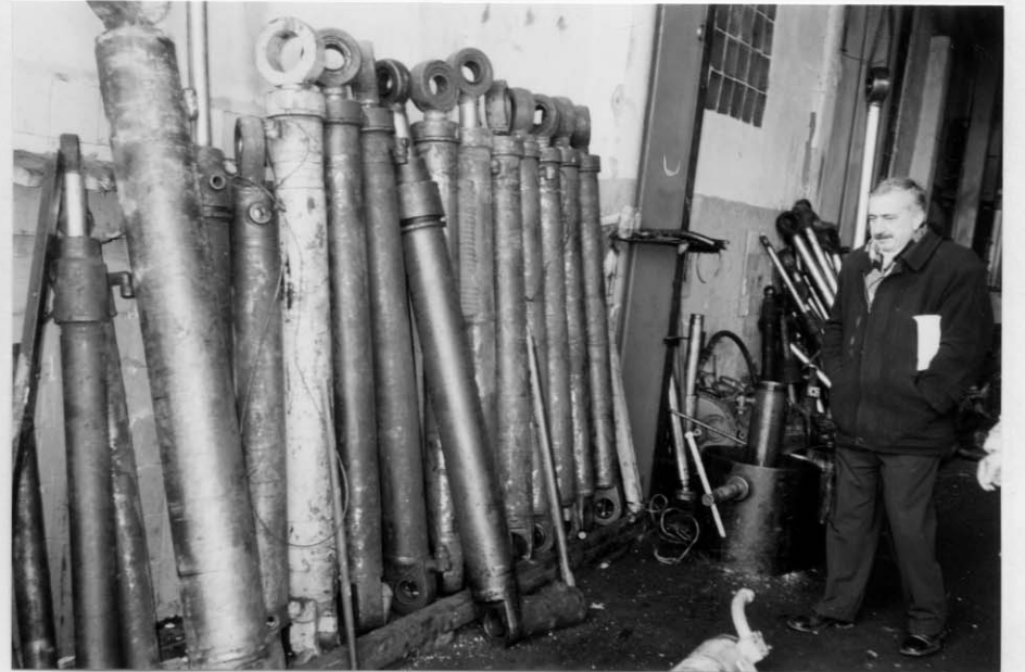
持ち込まれ再生作業を待つシリンダー類
