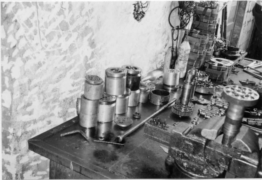
分解し、修復を待つプランジャーポンプ 当て板も使用せずに万力でくわえる。 (特殊工具を一切使用せずに分解/組立 を実施)
