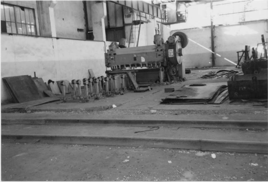
ここでは今でも橋梁の製作が可能な、シャーリングマシンや厚肉用溶接機がある。(最大 30mm) (ソ連製)
