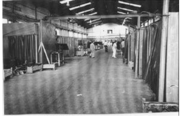
Usine de soudage Les lieux de travail sont séparés par des feuilles de vinyl rouge
