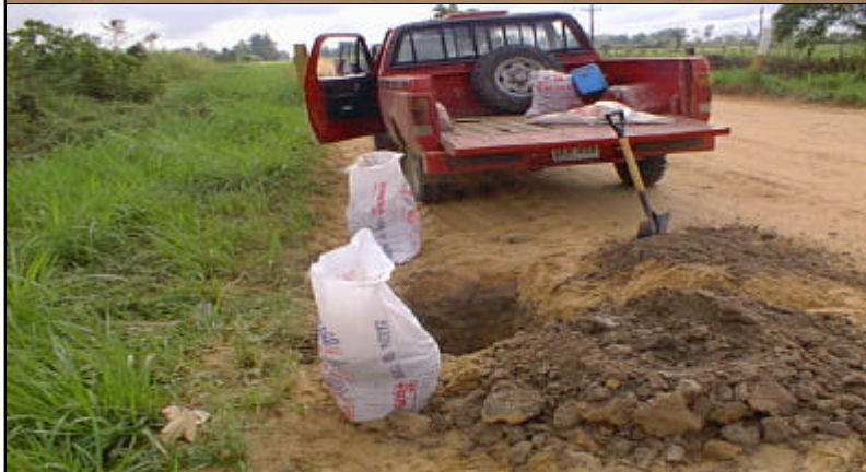
Condición de colección de material para prueba de CBR, km 9.
