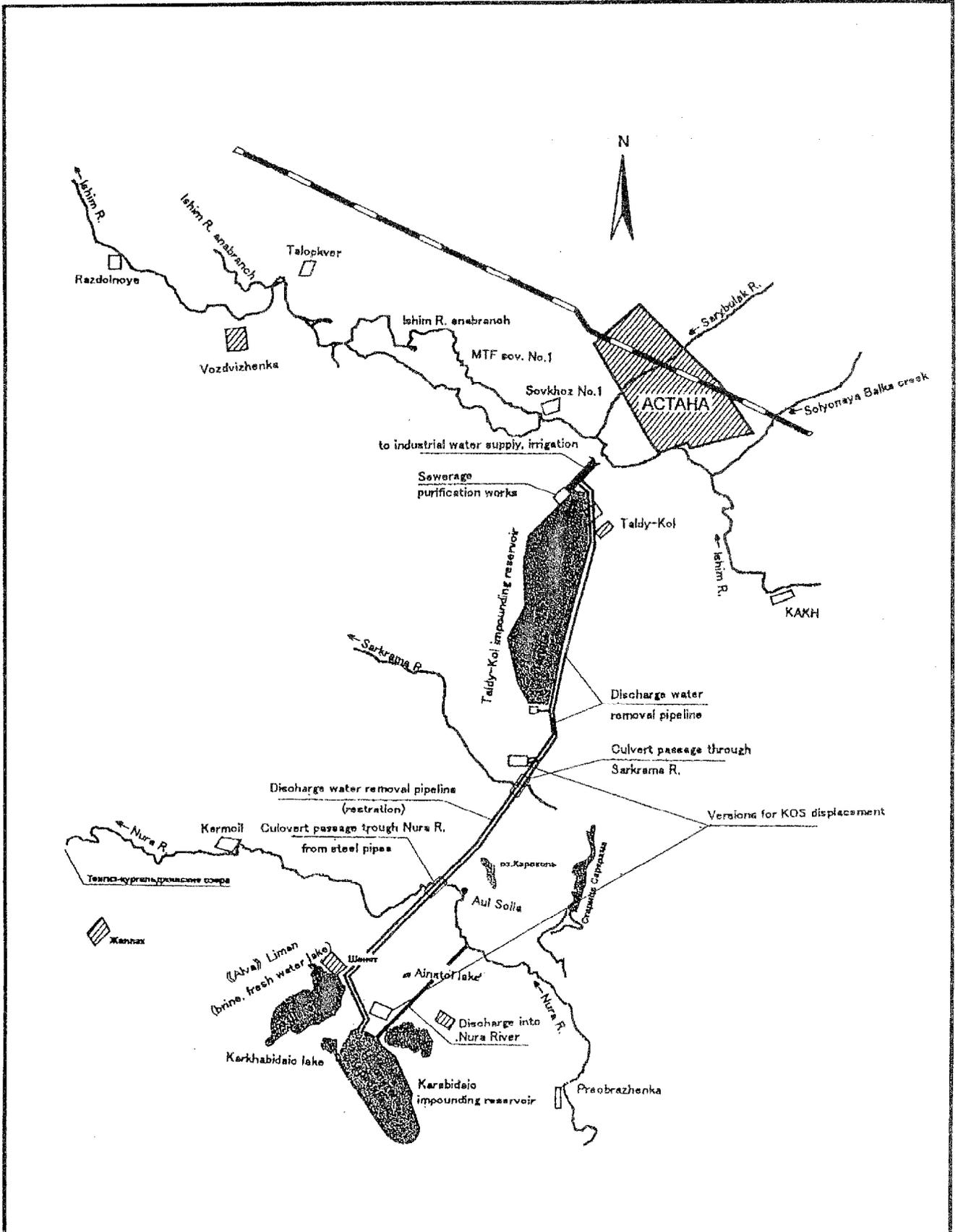
付図-7.2 アスタナ市汚水処理施設建設プロジェクトの全体施設概要
