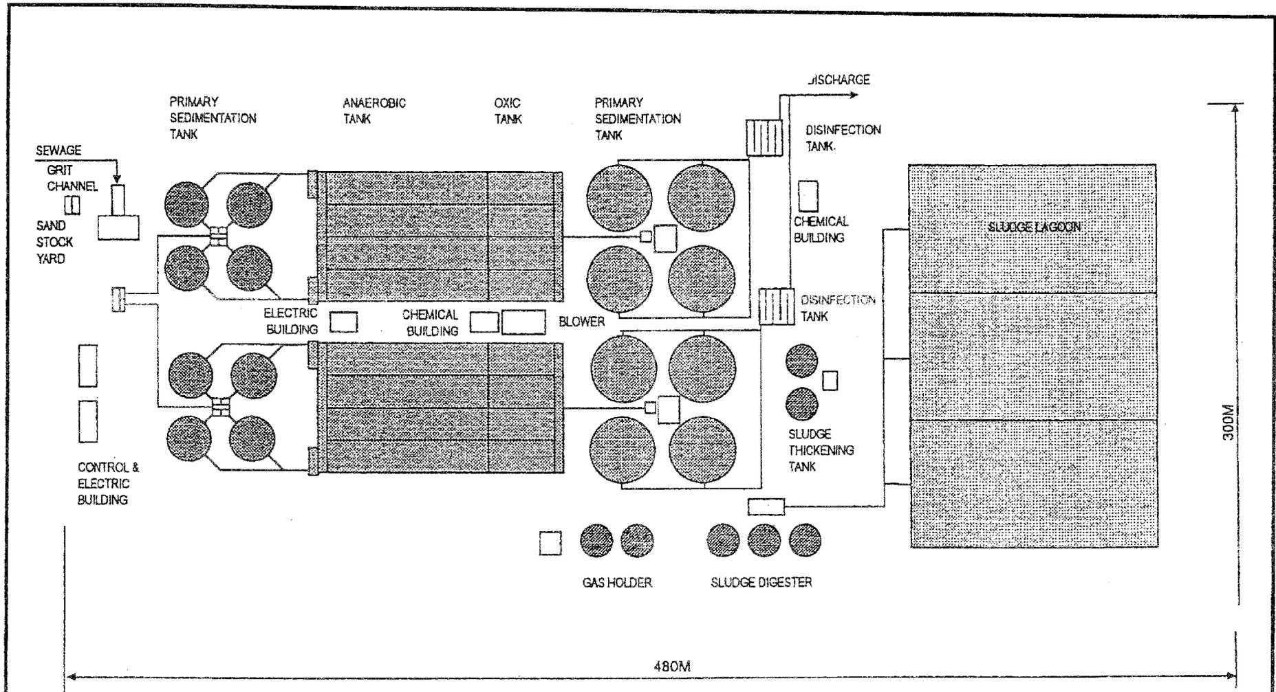
TYPICAL SITE LAYOUT OF NEW WASTEWATER TREATMENT PLANT
