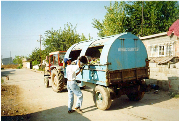
トラクタトレーラによる都市廃棄物収集（Yuregir DMの保有する収集車輛の75%はトラクタトレーラである）。
