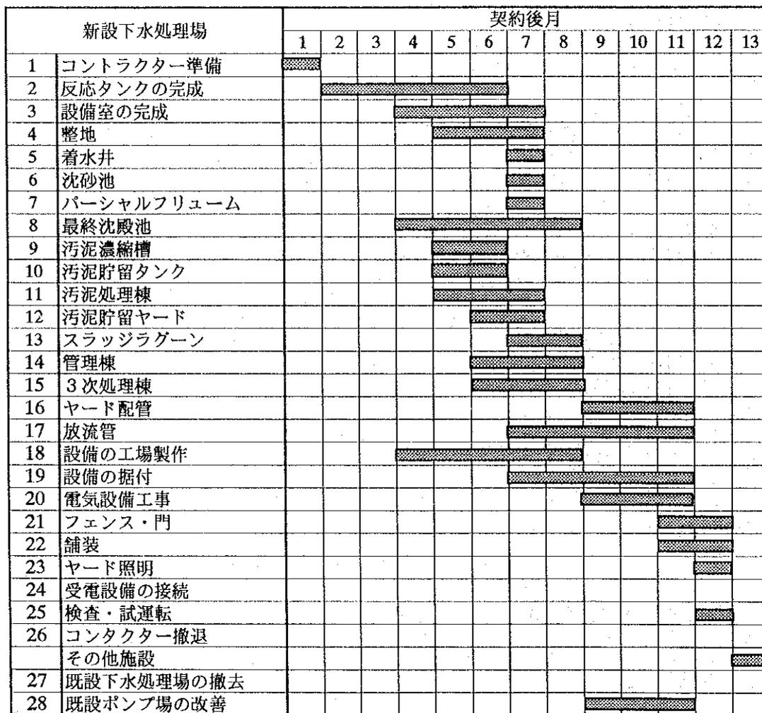
図 4.10 施設工事工程
