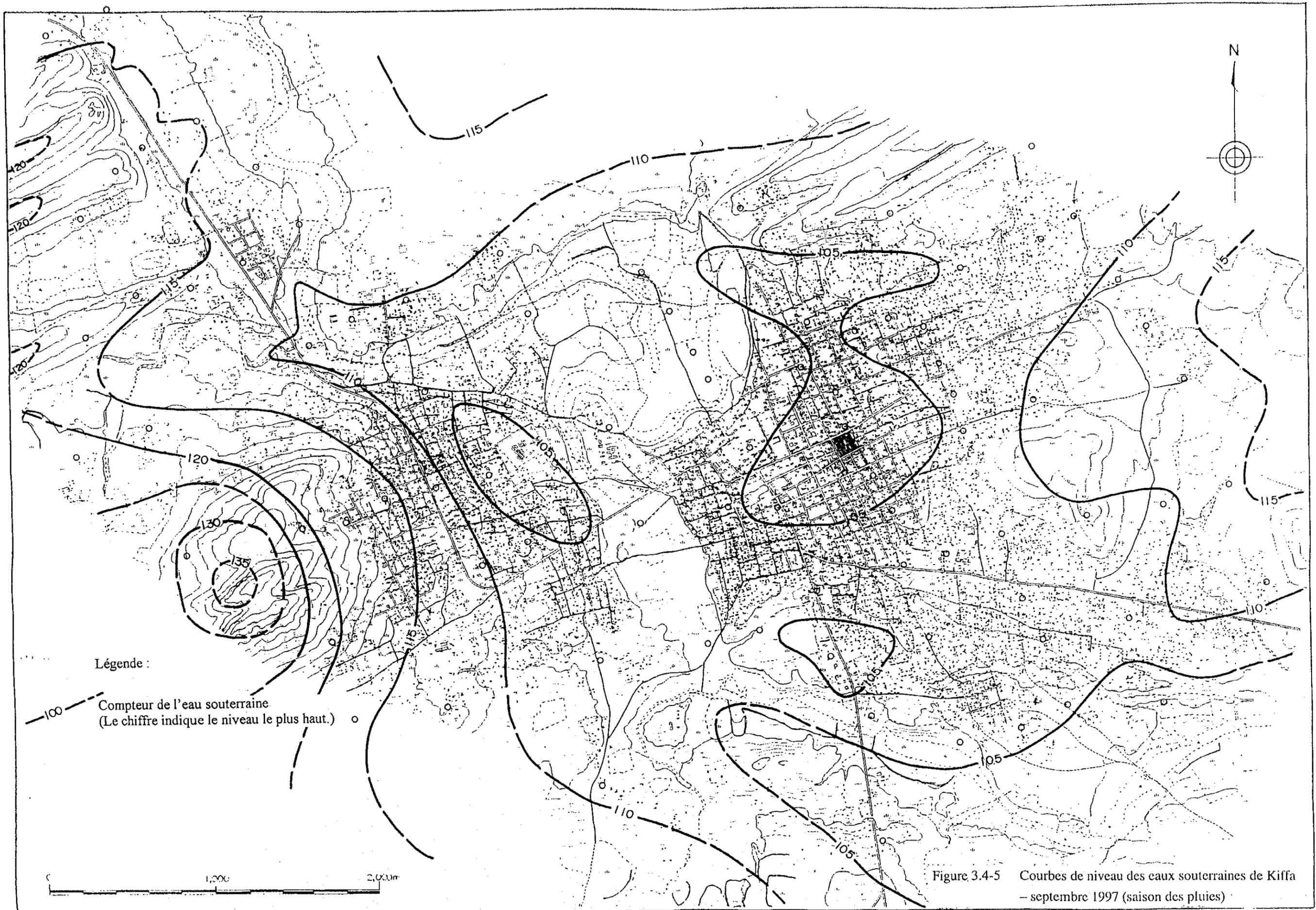
Figure 3.4-5 Courbes de niveau des eaux souterraines de Kiffa
