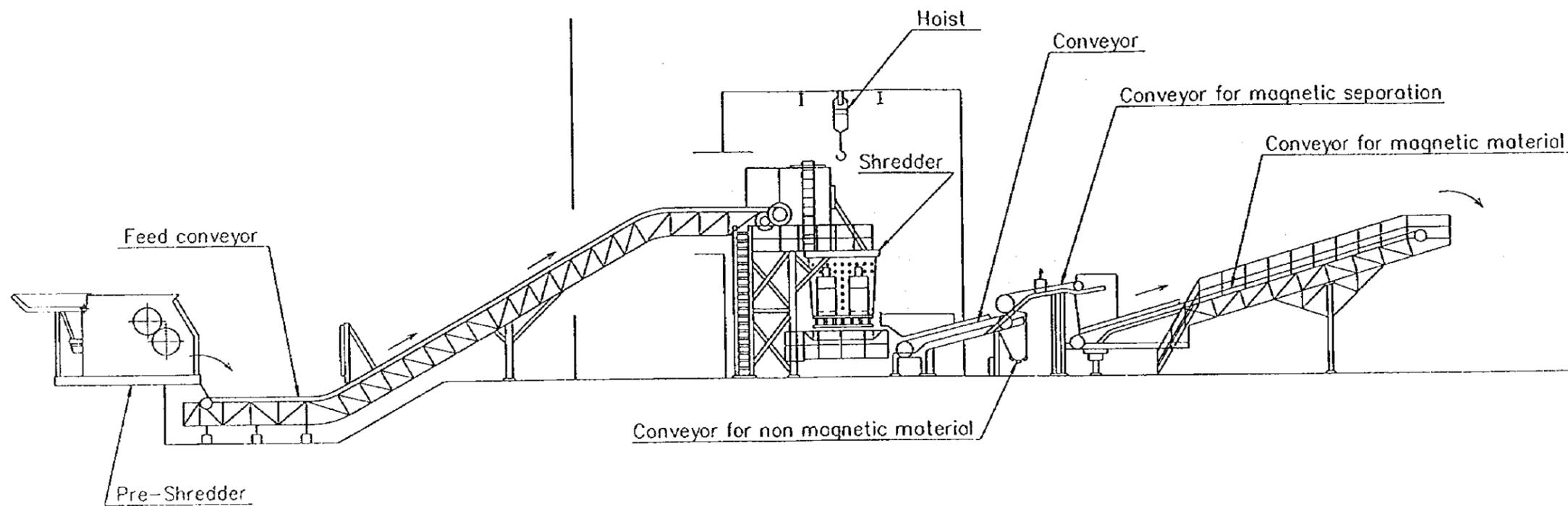
Figure 7.3-1 "Schéma d'écoulement mécanique"
