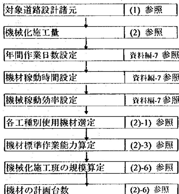
図-2 機材台数算定プロセスフロー
