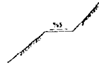
Şekil 4.6.10 Şevin Sert Kayadan Oluştugu Yerlerde Kademe Eğimi
