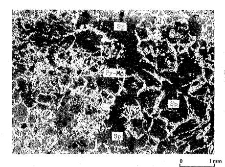
Sp : Sphalerite Py : Pyrite Mc : Marcasite
