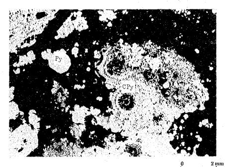
Py : Pyrite CPy: Colloform Pyrite
