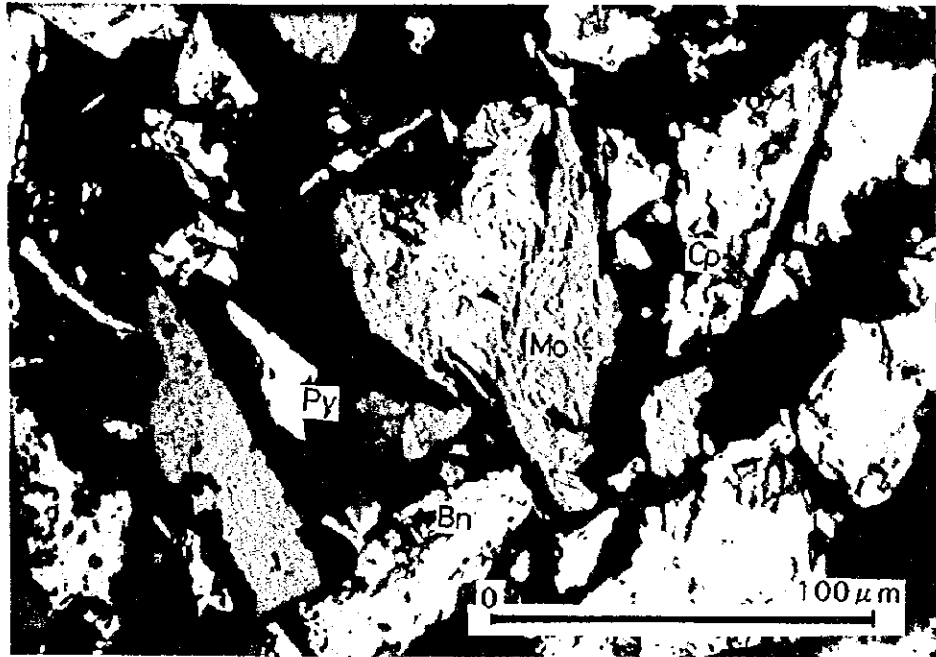
試料 T21-C1 黄銅鉱(Cp)、斑銅鉱(Bn)、黄鉄鉱(Py)。 網状フレークの輝水鉛鉱(Mo)を認める。
