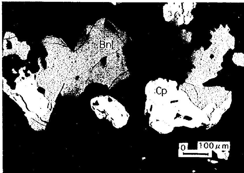
Muestra MJJ30-350 Paragenesis de calcopirita(Cp) y bornita(Bn)
